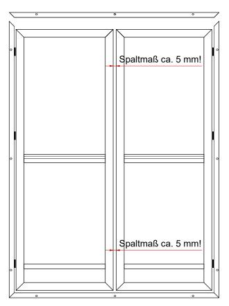
Der Mittelspalt kann durch Eckversätze und Addition unvermeidlicher Toleranzen ungleichmäßig sein, lässt sich aber korrigieren: Durch Eckjustierung bei der Rahmenverschraubung sowie seitlichen Druck im Scharnierbereich bei der Montage auf ca. 5 mm einstellen.
