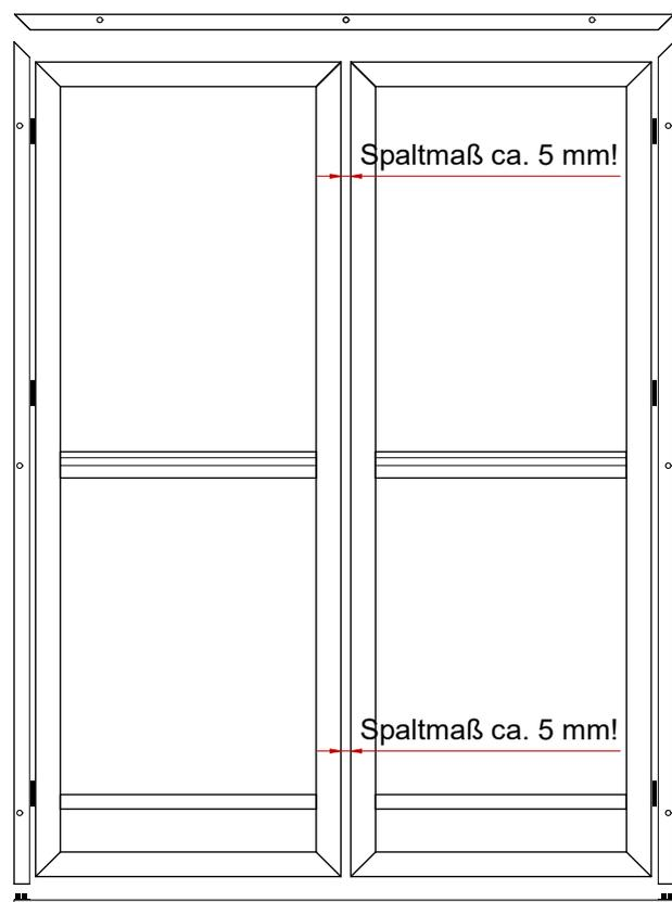
**Auf gleichmäßige Breite des Mittelspaltes zwischen beiden Türflügeln achten, diese lässt sich durch die Eckjustierung bei der Rahmenverschraubung noch beeinflussen.**
